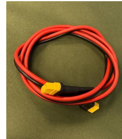
1.4 Кабель с XT 60 (Мама) для подключения к станции зарядки.
